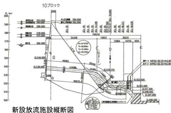
新設放流管および高圧スライドゲート設置状況
